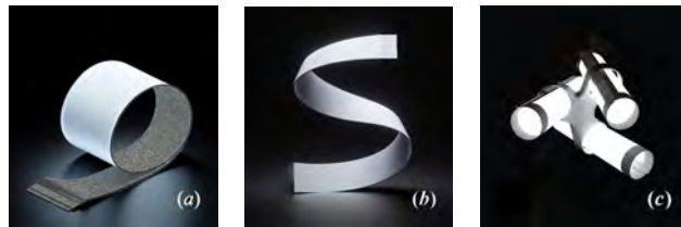
Figure 11.7-1 (a) White organic light-emitting diode (OLED) light panels can take the form of thin, lightweight, and bendable panels when fabricated on transparent plastic substrates. They can also take the form of rigid panels when fabricated on thin sheets of glass. Such panels offer large-area homogeneous illumination with little glare, and find use in LED lighting. (b) Conceptualization of a flexible transparent OLED (TOLED) light panel. (c) A captivating OLED luminaire constructed from flexible white OLED light panels. (Projet de fin d'étude réalisé en 2010 à l'ESDMAA, Institut du Design à Yzeure (France) par Elodie Saugues, Designer Produits Française à Stotzheim (France). Cette Lampe propose un nouvel usage de la lumière grâce à la technologie OLED. Une lumière qu'on manipule, qu'on emporte avec soi, grâce à ces trois feuilles autonomes et nomades que l'on peut enrouler ou laisser à plat. Les feuilles peuvent être regroupées grâce à un socle qui permet de les recharger par induction et de créer une lampe autoportée avec ces trois chandelles. Design by Elodie Saugues, reproduced with permission.)
