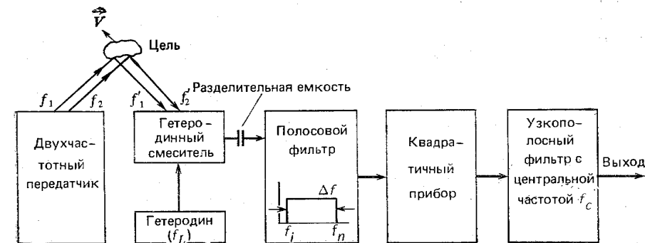
Рис. 7.3. Структурная схема трехчастотной нелинейной гетеродинной радарной системы
